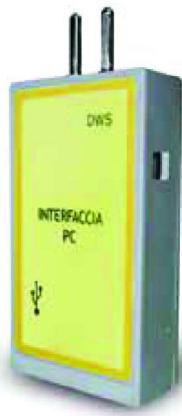
ارتباط دهنده رایانه‌ای تبادل داده‌ها بین همه تجهیزات سامانه تحویل آب و نرم افزار مدیریتی و همچنین به روزرسانی سخت افزاری آنها را امکان پذیر می‌سازد، این وسیله خصوصاً بر اساس عدم وابستگی به مودم ساخته شده و نیروی لازم برای تبادل داده‌ها را از یک پورت USB دریافت می‌کند.
