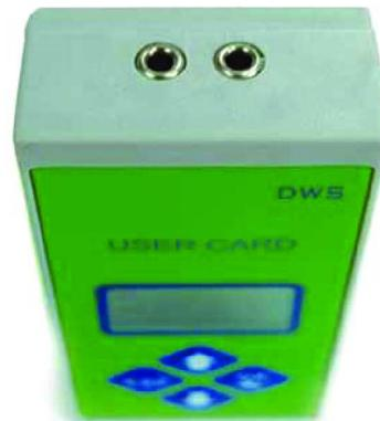
کارت اشتراک بوسیله یک رابط (فیش) موزی به دستگاه تحويل متصل می شود .
